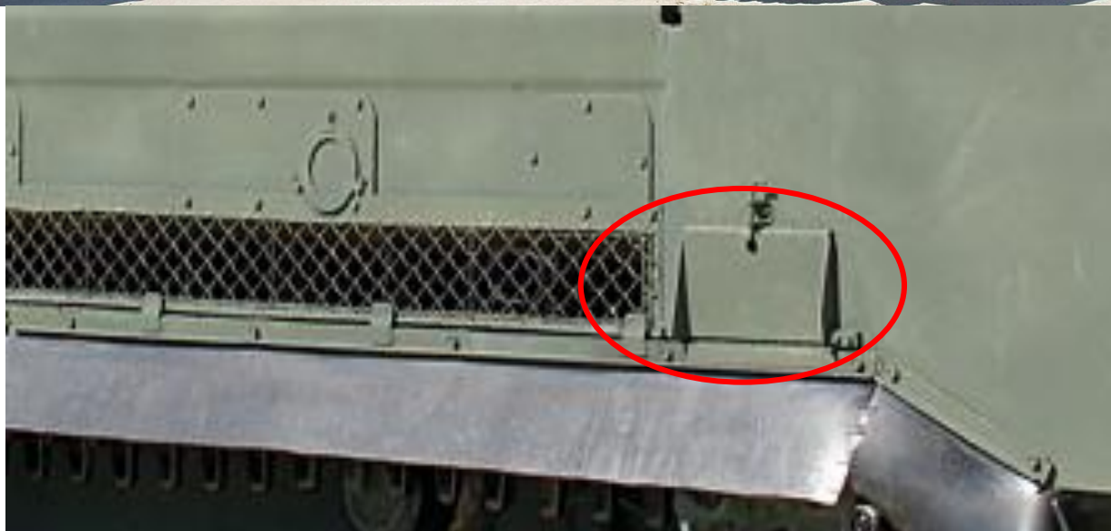
Фотография СОУ ЗРК «Бук» модификации 9А310М1-2 с откидной площадкой
